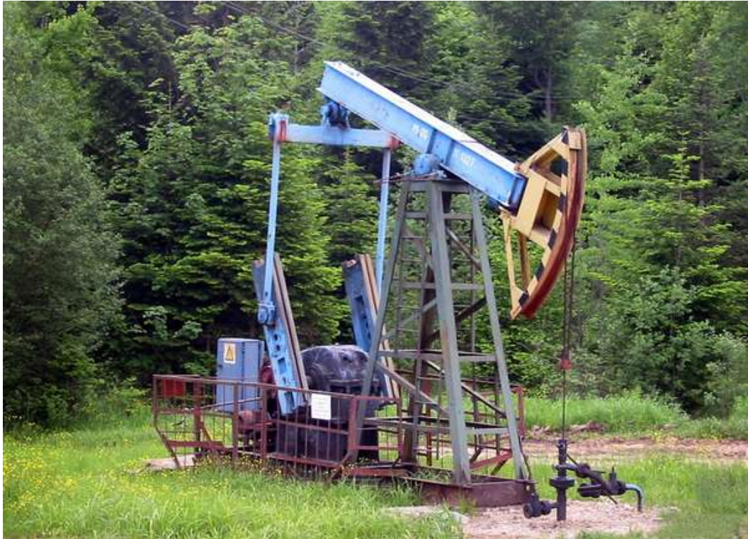
Рис. 1.- Свердловина НГВУ “Долинанафтогаз” №246-Д обладнана СШНУ з верстатую-гойдалкою UP-12Т (редуктор R-55 після 8 років експлуатації) (м. Долина).
